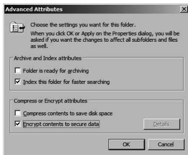
Рис. 5.28. В свойствах папки устанавливаем шифрование
